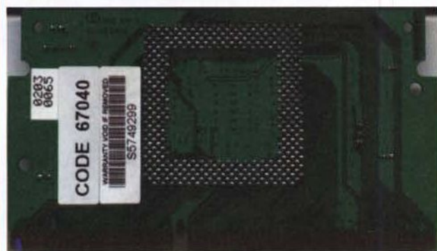
Figura 2 Per imporre la tensione di alimentazioni del nucleo a 2.2 V occorre isolare i pin A119, A121 e B119. L'isolamento si può mettere in atto utilizzando nastro adesivo isolante, scotch oppure nastro da pacchi.
